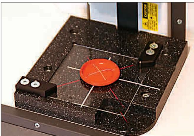
Laserzielkreuz erleichtert bei den kleinen Proben die punktgenaue Einstellung der Prüfnadel.
