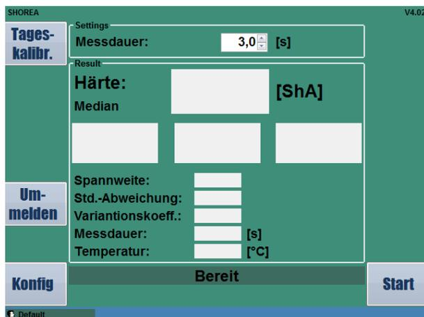
Durch Druck der Taste **[Konfig]** wird das Konfigurations-Modul gestartet und erlaubt spezifische Einstellungen zum Messablauf, Kommunikation und der Messwerkzeuge:
